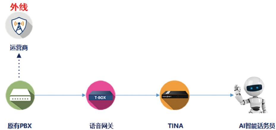
▲ 对接客户原有PBX,需加入对接网关和IP系统
