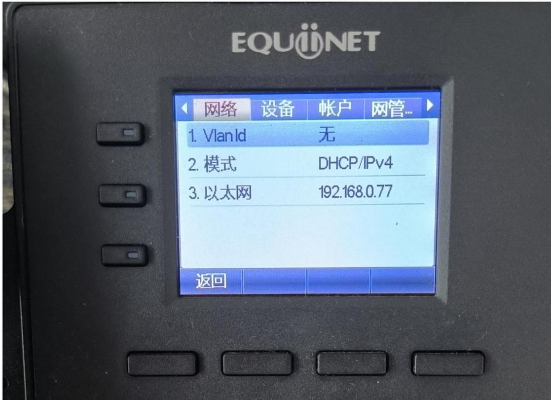
如果 POE 交换机没有自动获取地址，进入 “菜单>高级设置(要求输入密码 123)>网络>网络设置>IPv4”，网络类型改为静态 IP，手动分配静态地址。
