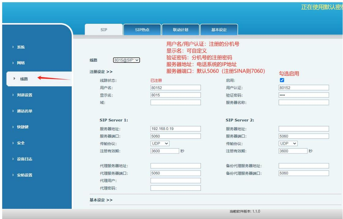
此操作也可以在话机端完成。进入“菜单>高级设置(要求输入密码 123)>账号”，选择线路。保存信息后，可以进入“菜单>状态”，查看账号的注册状态。
