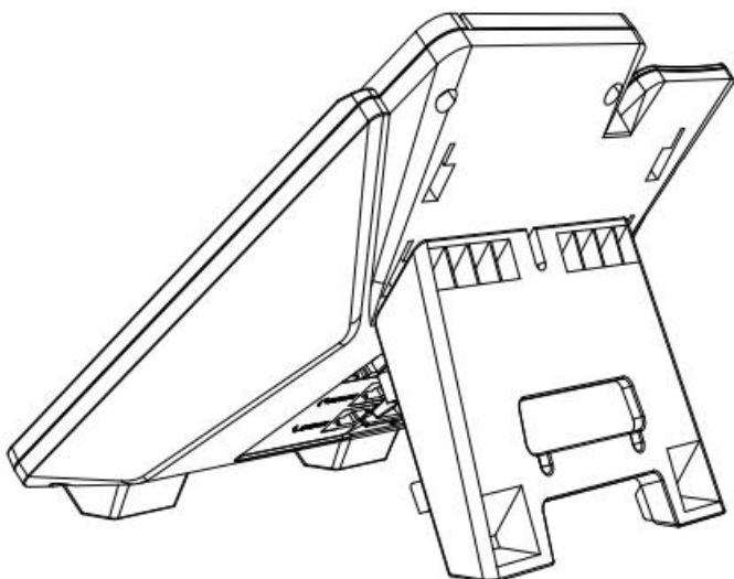
C. 拆卸脚架方法：按箭头方向向左拉出支架脚扣。如下图所示：
