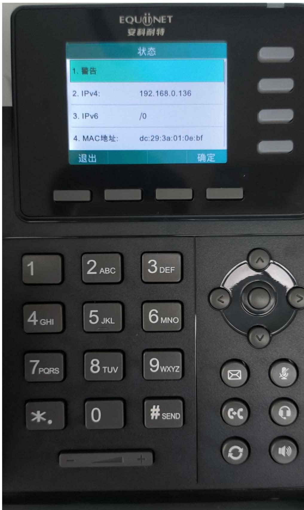
3. 如果接入的 POE 交换机下没有 DHCP 功能需要手动设置静态地址，进入“菜单>高级设置(要求输入密码 admin)>网络>WAN 端口>IPv4”，类型从 DHCP 改为静态 IP，手动设置 IP 后保存。
