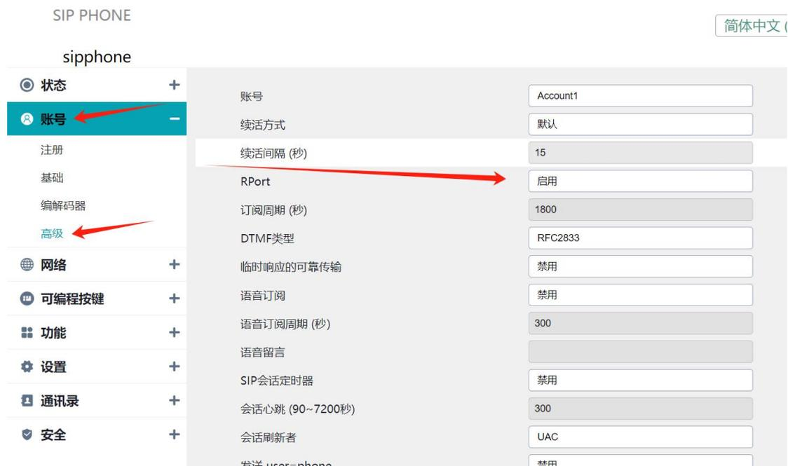
此操作也可以在话机上完成，进入“菜单>高级设置(要求输入密码 admin)>账号”，选择一个线路配置。参考下图
