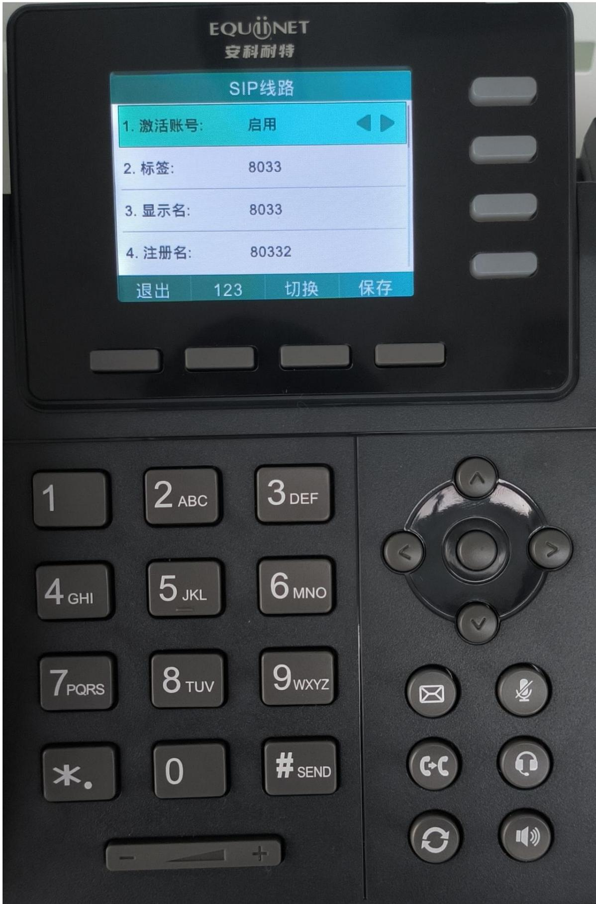
配置完 SIP 账号后，回到话机主页，电话图标显示绿色代表注册成功
