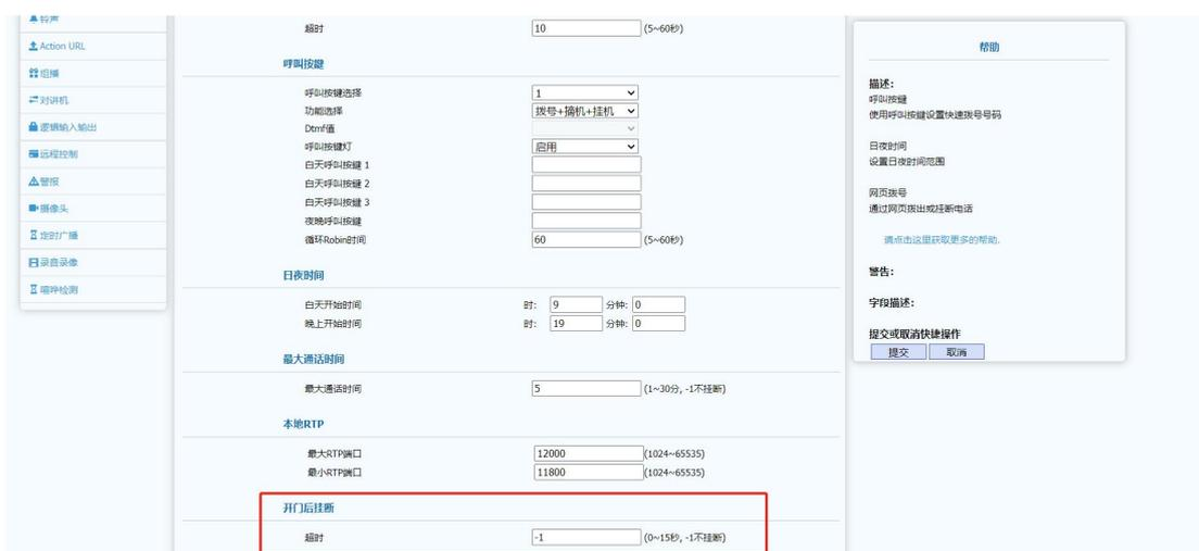
9. 设备>逻辑输入输出, 参考下图配置逻辑输入。逻辑输入出发通话填写呼叫目的地号码。如您想通过摄像机网关出发呼叫 8019, 您就填写 8019。
