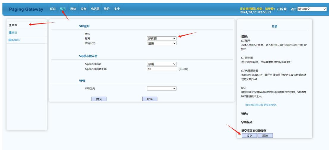
6. 账号>高级，选择对应的 SIP 账号（如果是 IP 直拨则选 IP 直拨），摄像头选择外部摄像头，如您使用华为烟火摄像机，外部摄像头 Url 填写 RTSP 流，格式为
