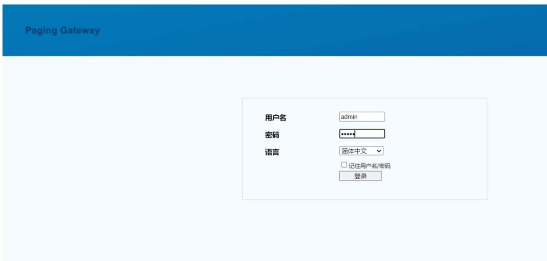
3. 进入网络>基本，修改静态 IP 地址，填写完后点击右侧的提交保存。
