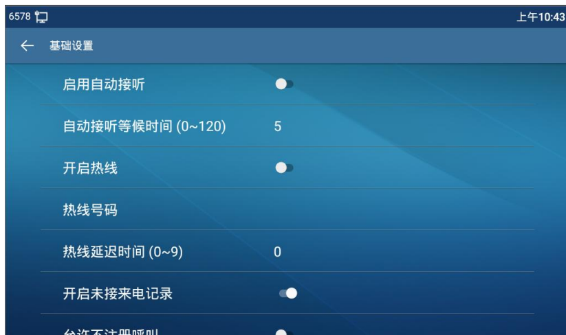
图 54 - 话机热线设置界面
