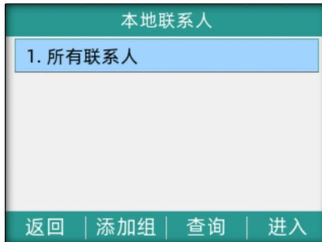
本地联系人用于储存联系人的姓名和号码。F14G 话机最多可储存 500 个联系人和 100 个群组。您可以添加群组，并为不同的群组添加联系人。您也可以从本地联系人中添加、编辑、删除、搜索或呼叫联系人。
